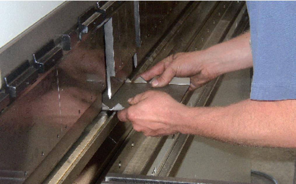
**Bild 1: Das Problem beim Abkanten ist die Nähe der Hände zur Gefahrenzone**
